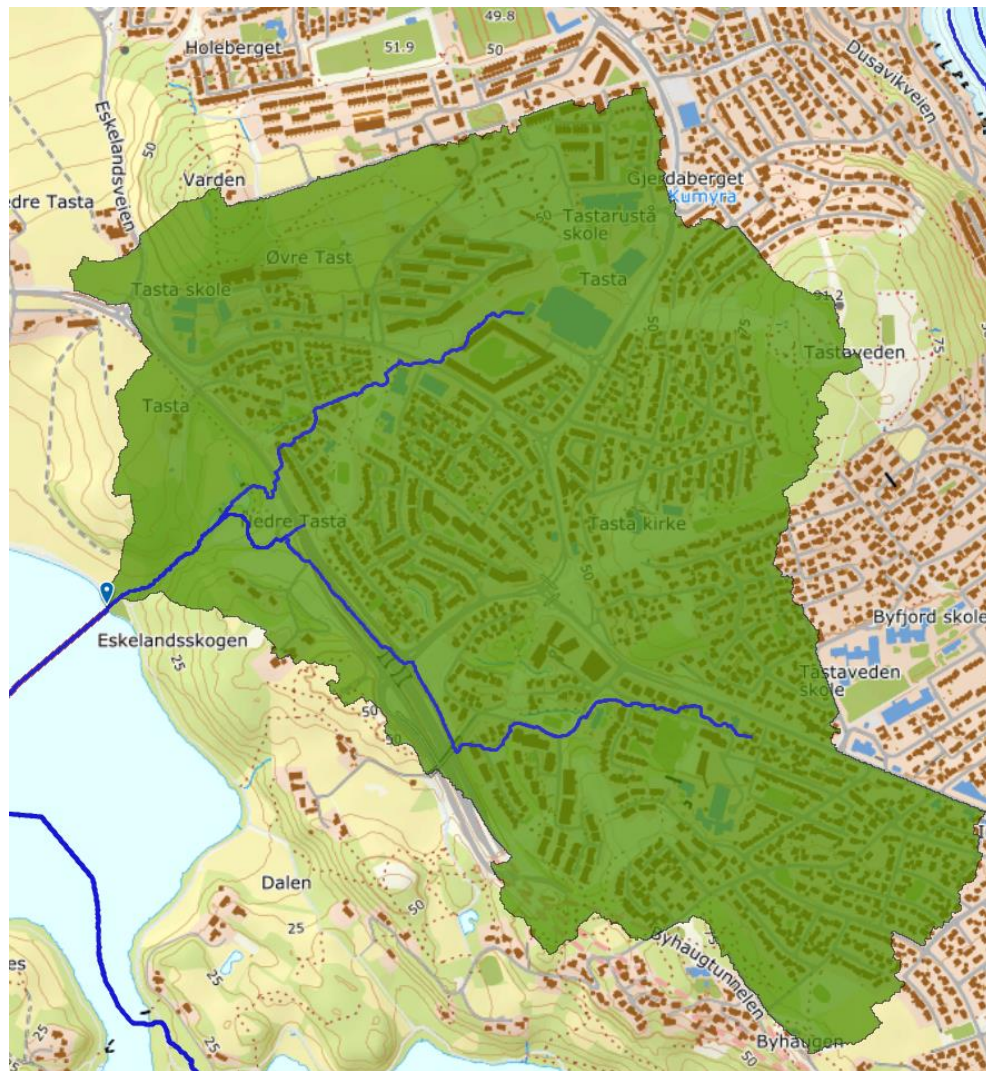
Figur 3-1: Eksempel på nedbørfeltinndeling. Feltet er gitt som området som drenerer til det gitte utløpet over land.
