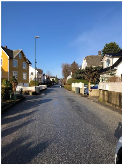
Figur 5-22 Fridtjof Nansens vei, mulighet med V-profil for å etablere flomvei i gaten.
