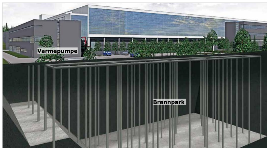
Figur 7-38 Eksempel på brønnpark med 90 energibrønner á 200 m for bergvarmepumpe ved Postens Østlandsterminal. Fjellvolumet utnyttes som et termisk energilager for oppvarming/kjøling.
