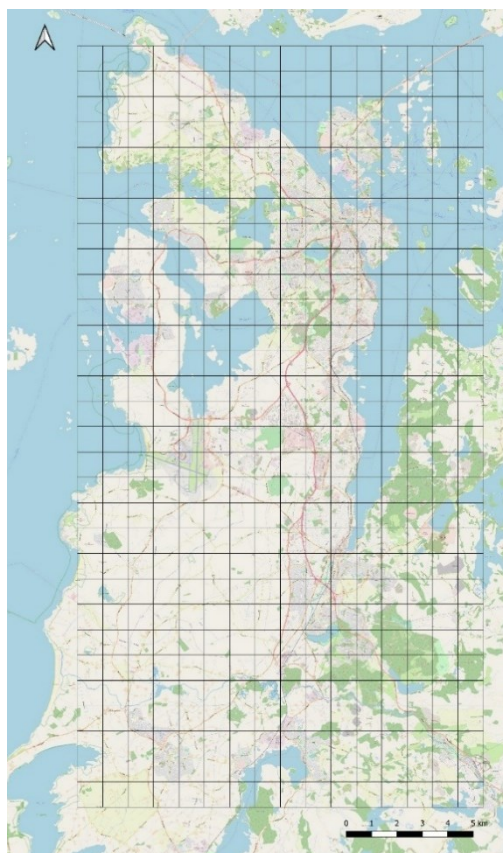
Figur 3-2: Modellområdet som er benyttet i utslipps- og spredningsberegningene for Stavanger omfatter et rutenett på 16 x 30 ruter på 1x1 km.
