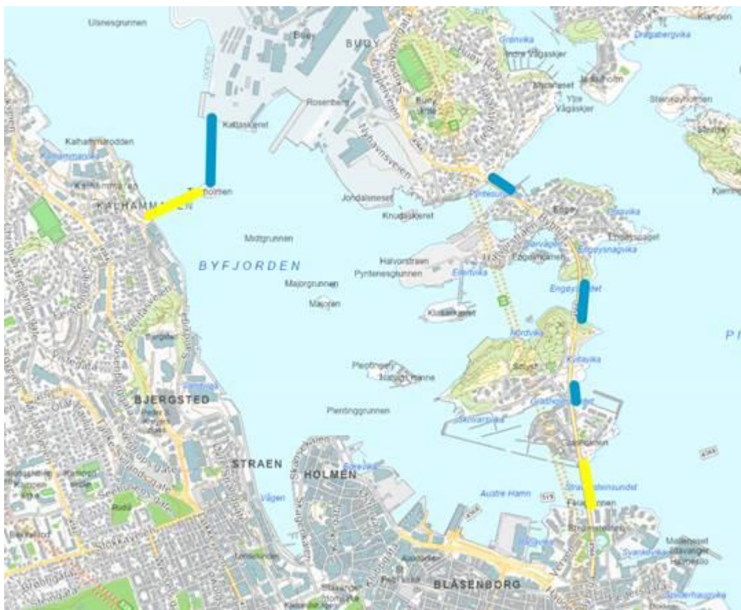
Figur 11-2: Eksempel på plassering av ytre barrierer. I dette eksempel er gul barrierer/sluser som kan stenges ved stormflo med båter som kan komme seg inn til vanlig, og lilla er permanent stengt. Det påpekes at dette er bare et eksempel og man kan tenke seg andre steder hvor man kan plassere barrierer.
