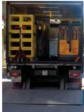
Bakløfter – felt helt ned. Inni bilen sees jekketralle og el-jekk. Bruskassene står på en pall.
