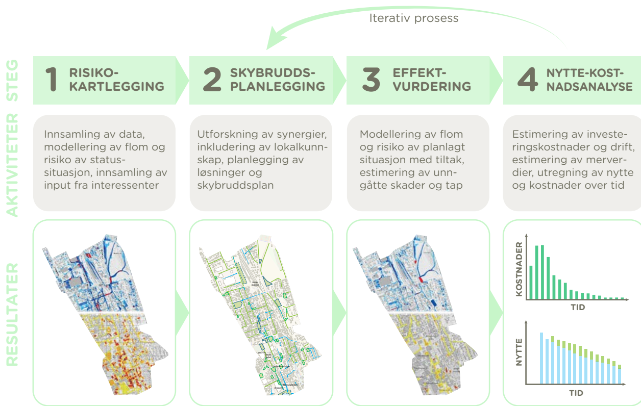
Figur 3.3: Stegene i en skybruddsplanprosess, som kan danne grunnlaget for fastsettelse av risikoakseptnivå (Figur: Rambøll)
